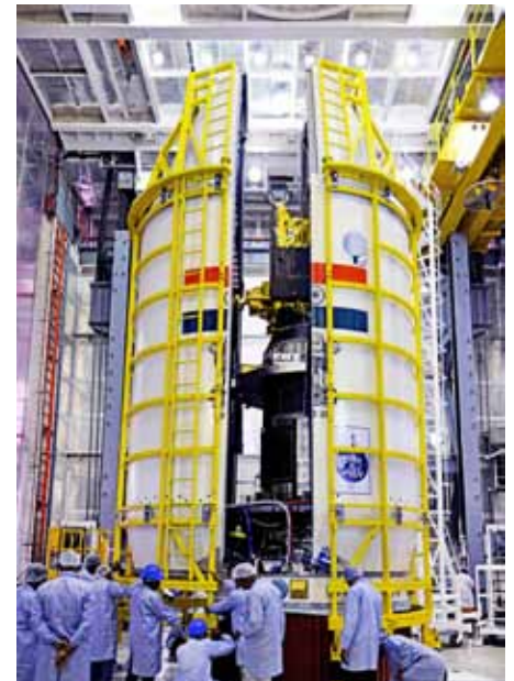
أعلى: المرحلة الأساسية (الأولى) من مركبة إطلاق الأقمار الصناعية القطبية سي 45 مع أربع حمولات داخل مبنى تجميع المركبات ؛
