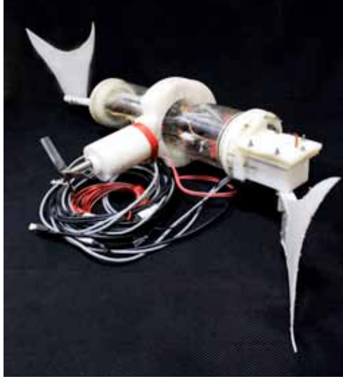
نموذج أولي للروبوت سيبيوي الي يعمل على تطهير خزانات الصرف الصحي
