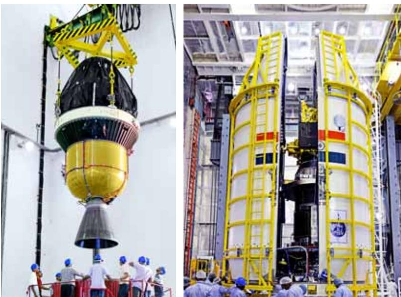
**En haut :** étage du noyau du PSLV-C45 (premier) avec quatre sangles à l'intérieur du bâtiment d'assemblage du véhicule ; **En bas (de gauche à droite) :** PSLV-C45, troisième et quatrième étapes au niveau du bâtiment de préparation
